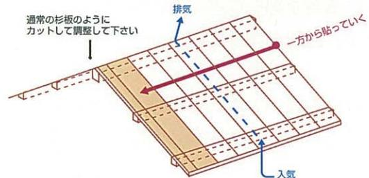
3. 軒先には先行して通気用の開口を設けることができます。径は18ミリで、長さ300ミリ程度の開口となります。開口の通気層側にステンレス製のネットを設けて、虫などが入らないように工夫をしております。
