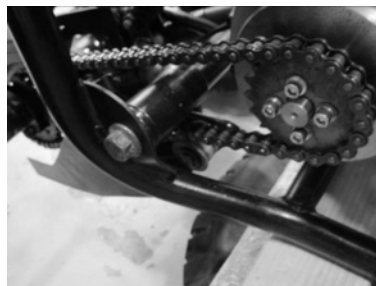
写真3. スプロケット、テンショナー取付 (耐チェーン寿命と動力伝達性能の向上)
