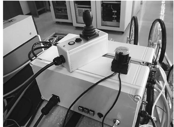
図2. ユニット、センサ及びリモコン操作BOX
