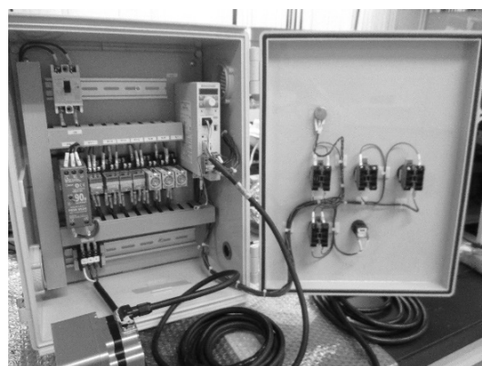
図 2. 従来品の内部構成 (アナログ式)
