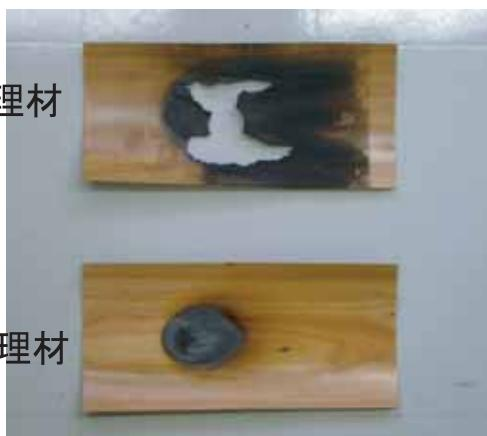
図1 燃焼試験結果
