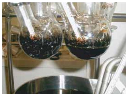
図2 ニトロベンゼン中200 °Cで3時間加熱後のs-NBR（左）及びAB-copolymer（右）
