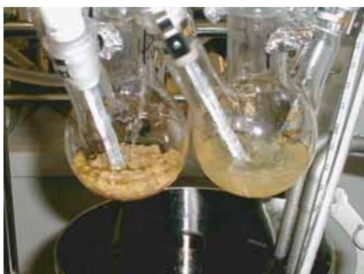
図1 DOP中200 °Cで3時間加熱後のs-NBR（左）
