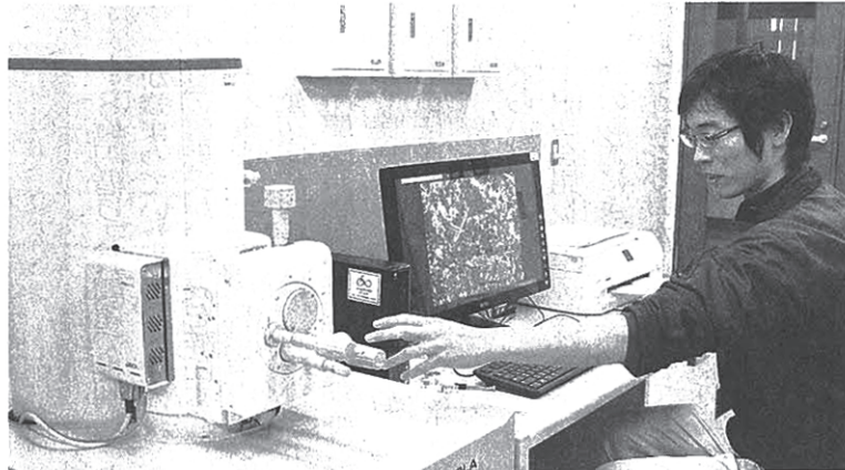
県立工業技術センターが導入したエネルギー分散型微 小部分析装置—徳島市
