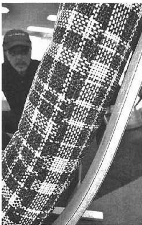
【上】CFRPを挟んだ椅子のフレーム。板野町の富士フアニチア。【下】椅子のフレーム構造材に取り入れたCFRP。県立工技センター
