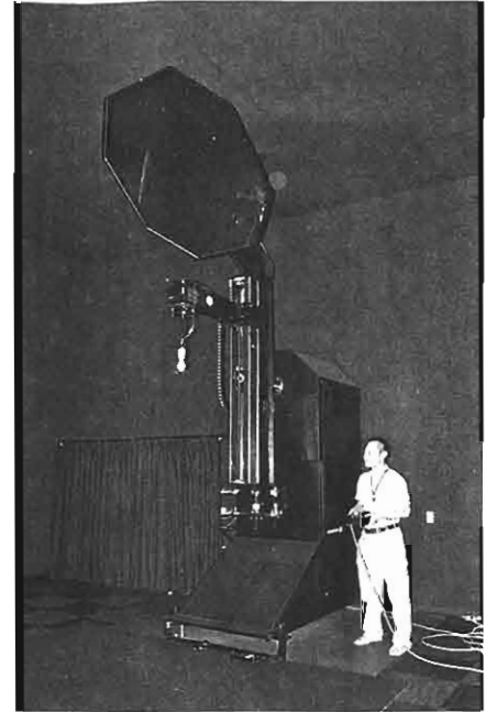
LED照明器具の光量を測定する配光測定装置＝徳島市の県立工業技術センター
