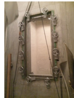
音響透過損失の測定
