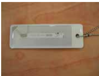
図 2 防水型として利用できる封入型 IC タグ
