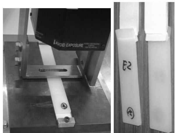
ラインビーム溶着機の溶着部(上)と溶着試験片(下)
