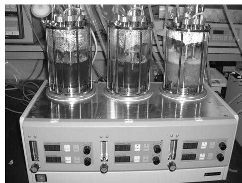
図1 ジャーフェーマンターによる酢酸発酵試験
