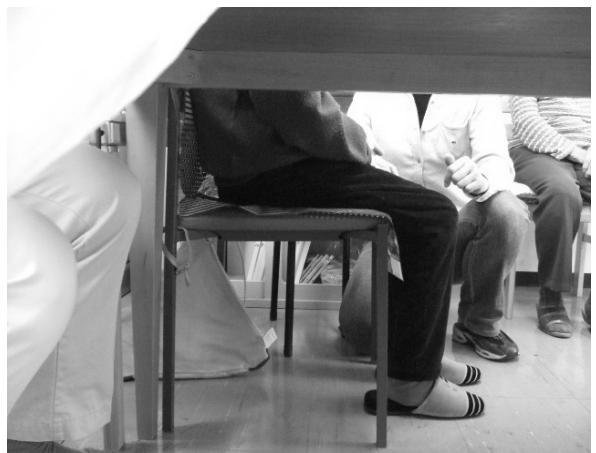
図1 改良前の椅子座体圧測定
