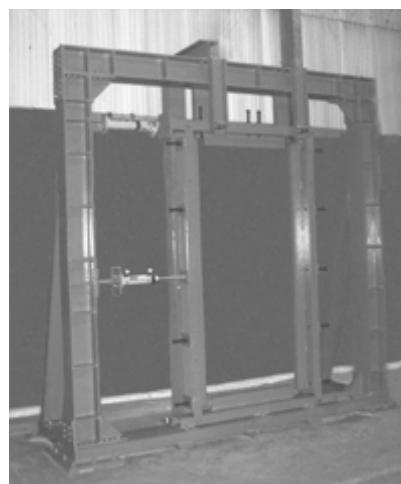
図2 耐震性能試験用治具の外観
