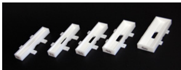
図1 傾斜をつけた光反射板
