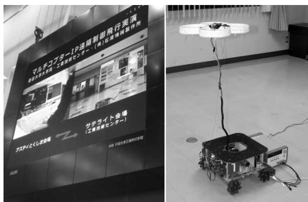
図2. 左) 飛行デモンストレーションの中継映像配信、右) 遠隔制御用マルチコプター (徳島大学製作)
