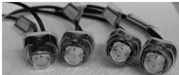
写真1. 一ヶ月間の水中照射試験後のユニット外観
