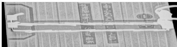
図2. ソーラセル電極部の軟X線による観察
