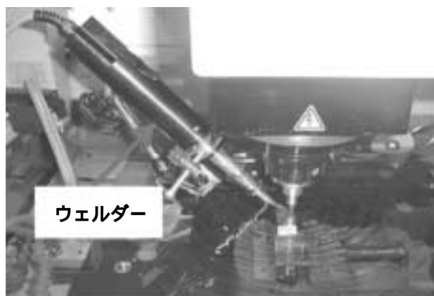
図1 超音波振動複合放電加工の状態図
