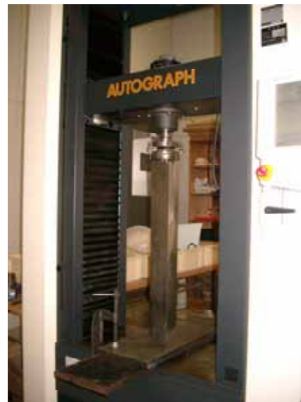
図 1 材料試験機による圧縮試験方法
