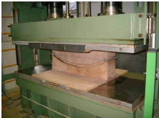
図2 プレスによる曲げ木試験
