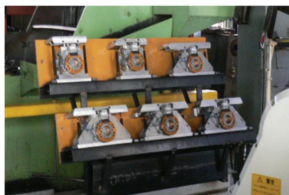
図12 簡易架台と6種の箱詰め用ハンド
