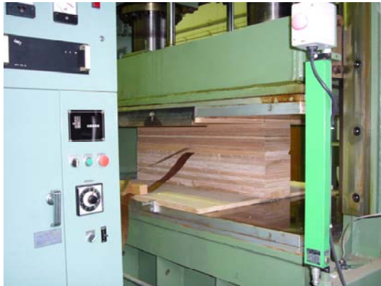
図1 直線型による高周波加熱成型加工
