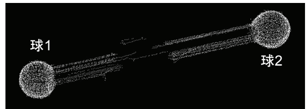
図6 球間距離測定用標準器の立体形状モデル
