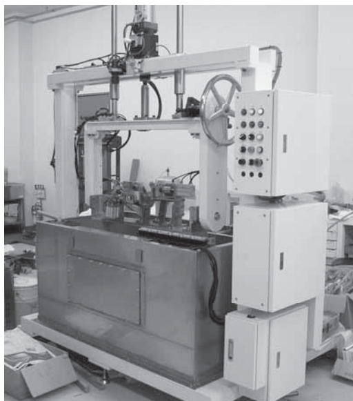
図2 実験装置(水没式リークテスター)
