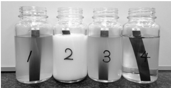
図1 各種水溶性切削油剤に浸漬させた CFRP
