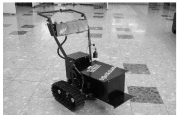
図 4 試作モータを取付けた小型電動車両 試作1号機
