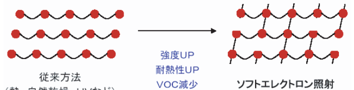
図2 ソフトエレクトロンによるポリマーの架橋反応
