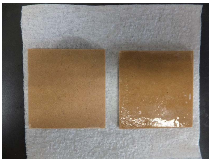
図2. コーティング・UV硬化後の試験片 (左:1回, 右:2回)
