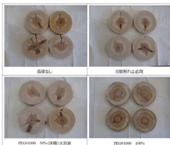
図1 割れ止め比較試験
