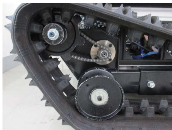
図1 電磁ブレーキシャフトとディファレンシャルギア軸の連結機構
