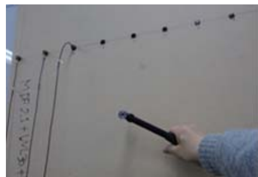
図3 インパルスハンマーと 加速度センサーによる振動試験
