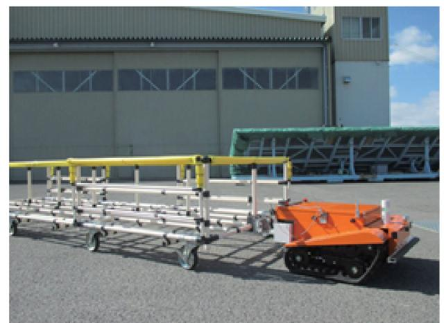
図4 開発中の搬送ロボット
