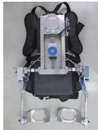
図2 機構開発のアシストスーツ試作
