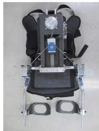
図1 CFRP使用のアシストスーツ試作
