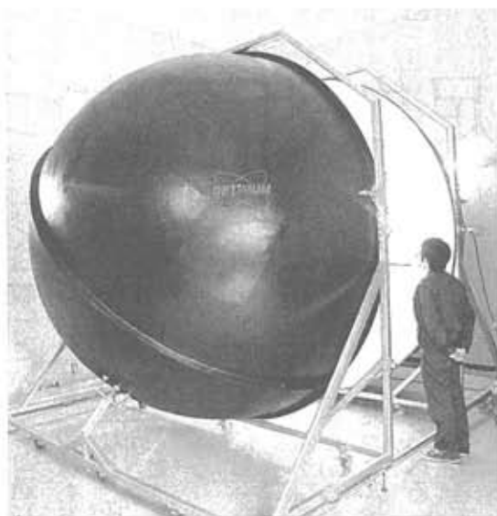
【上】LED照明の光源の明るさを測定する全光束測定装置【下】光の広がり具合を図る配光測定装置―いずれも県立工業技術センター―
