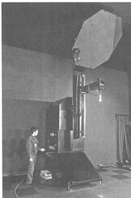
【上】LED照明の光源の明るさを測定する全光束測定装置【下】光の広がり具合を図る配光測定装置―いずれも県立工業技術センター―
