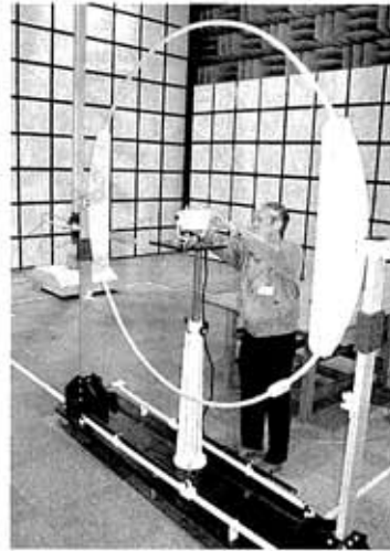
LED製品から出る電磁波の強さを測るレーザーアンテナ―徳島市の県立工業技術センター
