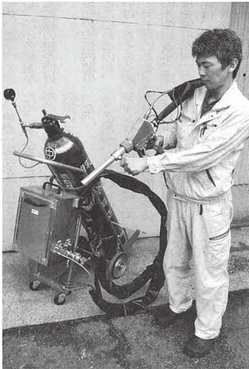
クールテクノスが開発した低コストで作業性に優れたドライアイス洗浄装置＝鳴門市
