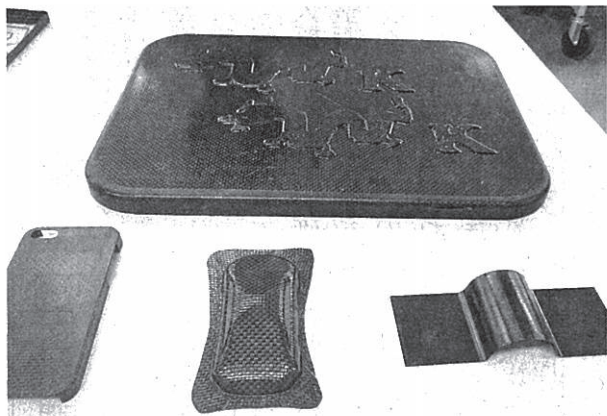
県立工業技術センターが試作したCFRP製品—徳島市の同センター
