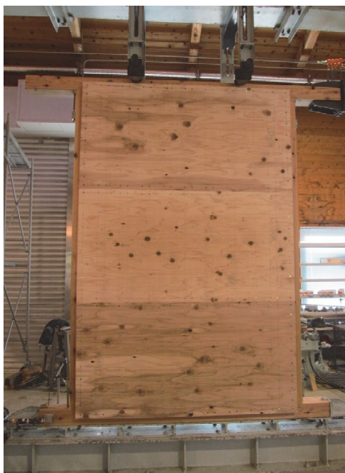
図2 試験体（スギ合板側 上面）
