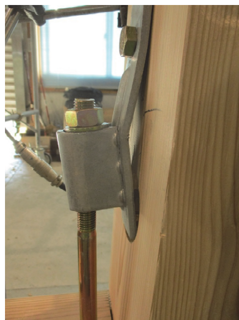
図 8 ホールドダウン金物の変形例
