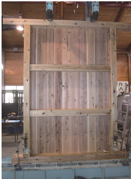
図3 試験体（スギ厚板側 下面 現し）
