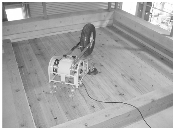
図1 供試床の設置
