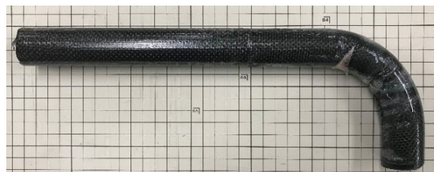
図 10 連結樹脂型で成形した CFRP パイプ
