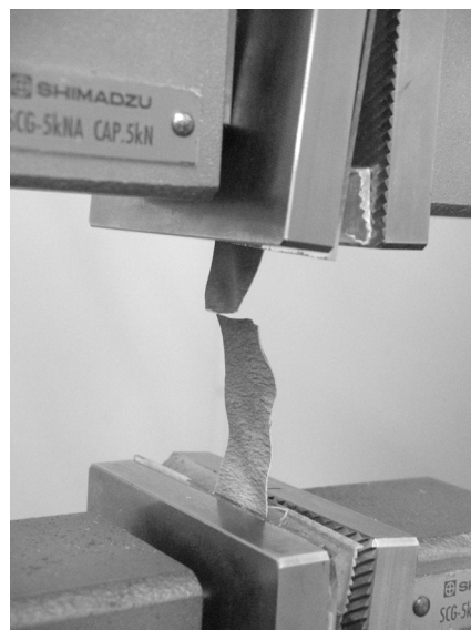
図1 CNFシートの引っ張り試験
