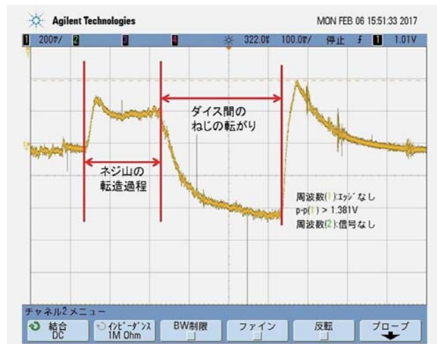
図2 試作したAEセンサで測定した結果
