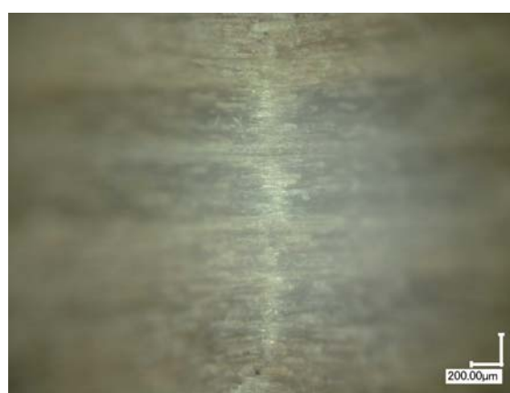
写真1 通常塗装突き板（左）とNS-48塗装突き板（右）シートの繊維直交方向の曲げた後の表面
