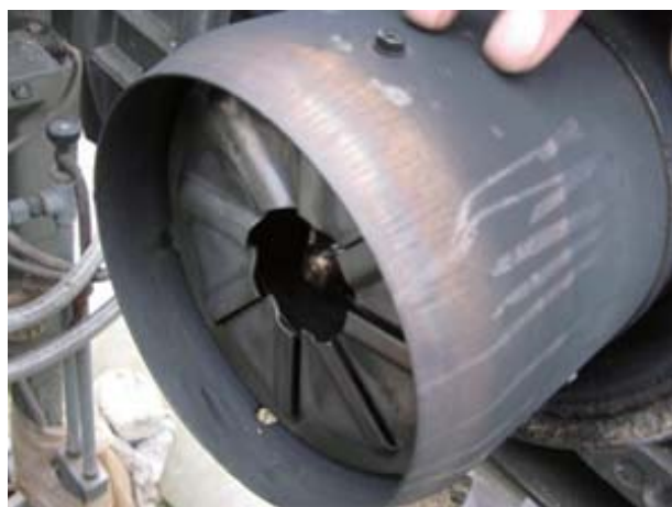
写真1. 口金部への塗料塗布
