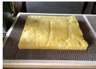
図2. ハニカムコアの削減と多孔質材料の充填の様子
